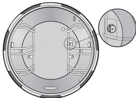
Pendant la phase de refroidissement, de l'eau est pulvérisée dans l'enceinte du four par le gicleur situé derrière la plaque de protection du support de gradin droit. Cette buse peut s'encrasser et s'entartrer après une utilisation intensive.
