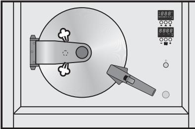
Si elles se déclenchent, la vapeur sort par au-dessus et en dessous de la fermeture de porte.
