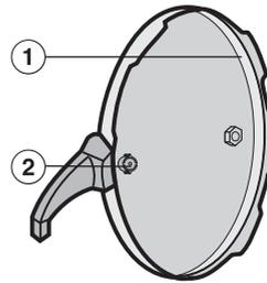
Le joint ① et la vanne de sécurité ② doivent être remplacés après 1 ou 2 ans, en fonction de la fréquence d'utilisation du four. Remplacez les deux pièces en même temps.
